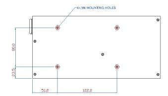
Trous de montage : 4 x PEMs filetés M4 sur la base. La pénétration maximale des vis est de 2 mm de la base. 2 x PEM à filetage M3 de chaque côté. La pénétration maximale des vis est de 2 mm sur le côté.
