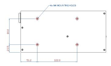
Trous de montage : 4 x PEMs filetés M4 sur la base. La pénétration maximale des vis est de 2 mm de la base. 2 x PEM à filetage M3 de chaque côté. La pénétration maximale des vis est de 2 mm sur le côté.
